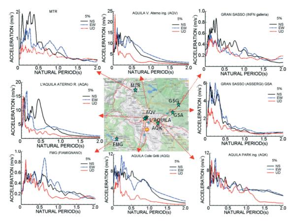
Figure 10. Acceleration response spectra of selected strong motion stations. Şekil 10. Seçilmiş kuvvetli yer hareketi istasyonlarının ivme tepki spektrumları.
